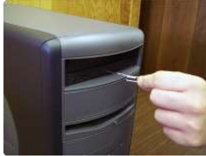
Gambar 3. 24 Membuka tray CD/DVD drive dengan paper clip
