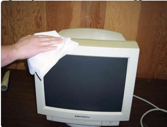
Gambar 3.16 Membesihkan bagian luar monitor dengan lap basah
