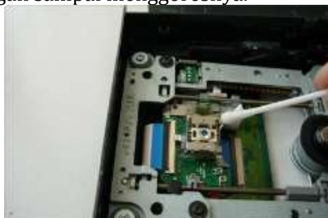
Gambar 4.17 Bersihkan lensa dengan kapas yang sudah diberi cairan pembersih
