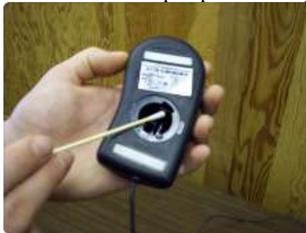
Gambar 3. 23 Bersihkan bagian dalam mouse dengan kapas pembersih
