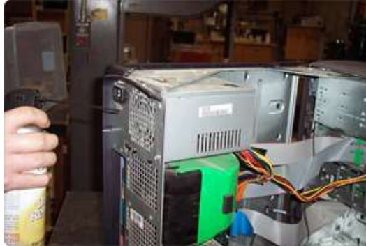
Gambar 3. 13 Membersihkan bagian dalam casing
