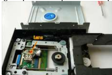
Gambar 4.16 Lepas baut pada drive optic dan cari optiknya
