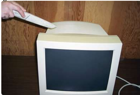
Gambar 3.15 Membersihkan monitor dengan vaccum cleaner.
