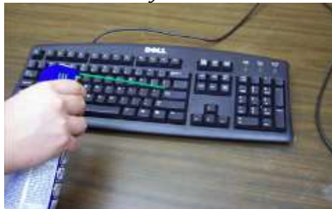
Gambar 3. 19 Membersihkan tuts keyboard dengan penyemprot
