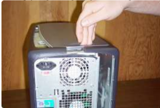
Gambar 3.11 Membuka casing komputer
