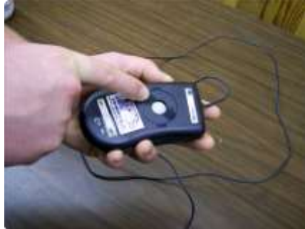
Gambar 3.22 Membuka penutup mouse
