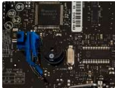
Gambar 4.5 Buzzer pada komputer
