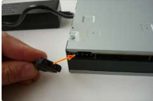
Gambar 4.15 Lepaskan kabel power dan kabel IDE CD Drive
