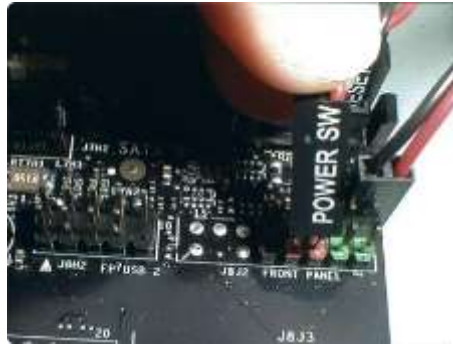
Gambar 4.12 Pastikan kabel power dari motherboard yang ter- hubung ke tombol panel depan
