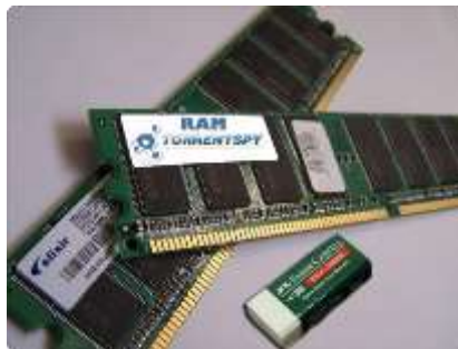
Gambar 4.13 Bersihkan pin RAM dengan karet penghapus
