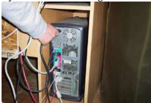
Gambar 3.9 Lepaskan kabel daya
