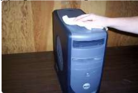
Gambar 3.10 Menyeka debu dengan kain lembut
